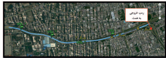
شکل ۵: نقشه تجهیزات و تقسیم بندی به قطعات برای کنترل با سامانه سرعت
