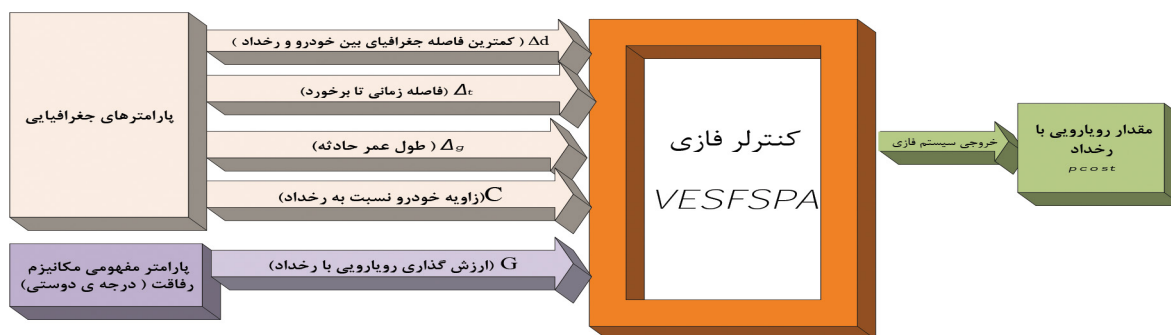
شکل ۲: بلوک دیاگرام از ورودی و خروجی سیستم کنترل فازی
