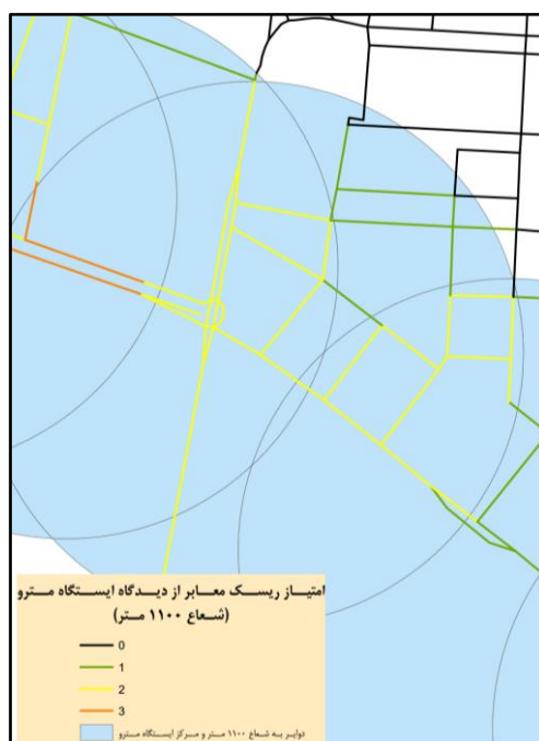
شکل ۳. امتیاز ریسک حمل مواد سوختی در کمان‌های قرار گرفته در فاصله کمتر از ۱۱۰۰ متر از چند مرکز حساس
