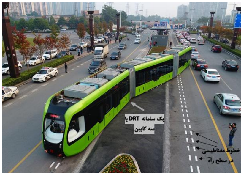
شکل ۱. نمونه‌ای از یک سامانه DRT سه کابینه مورد بهره‌برداری در شهر شانگهای چین
