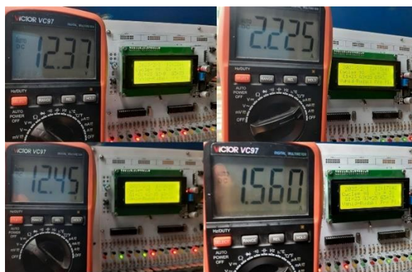
شکل ۹. میزان جریان و ولتاژ ورودی‌های دستگاه کنترل دیجیتال حین مدیریت تقاطع وحید-رودکی
